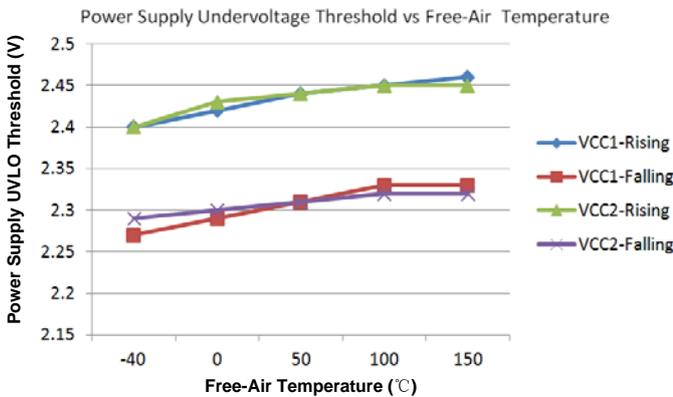
图 9-5. 电源欠压阈值 vs.
