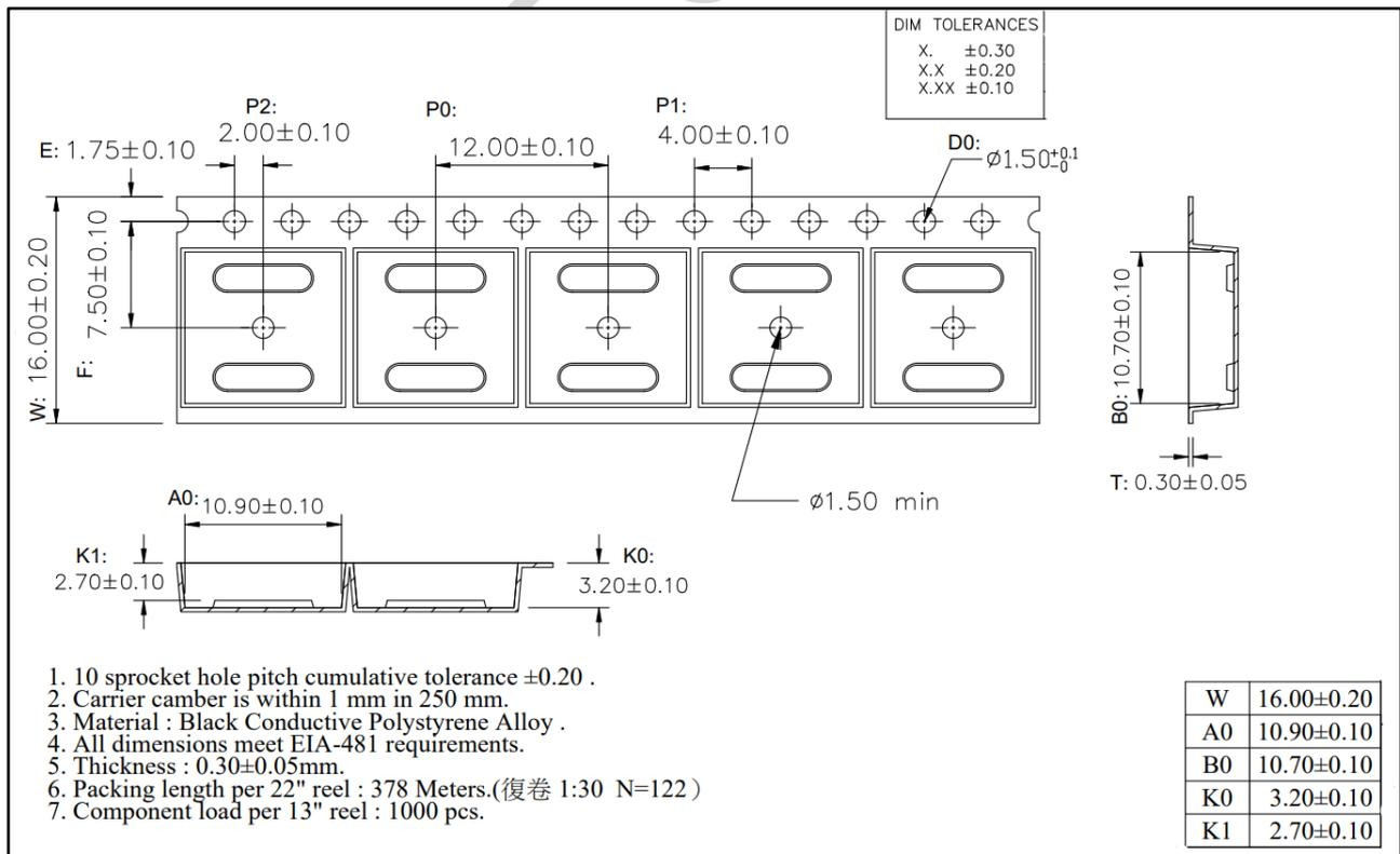
图 16. CMT804X WB SOIC-16 编带信息
