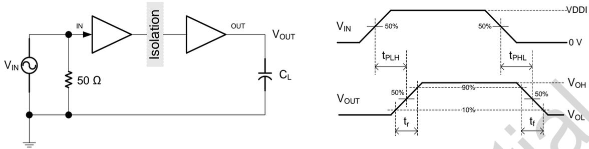
图 6. 开关特性测试电路及波形
