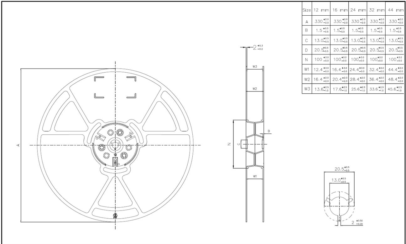
图 15. CMT804X WB SOIC-16 卷带信息
