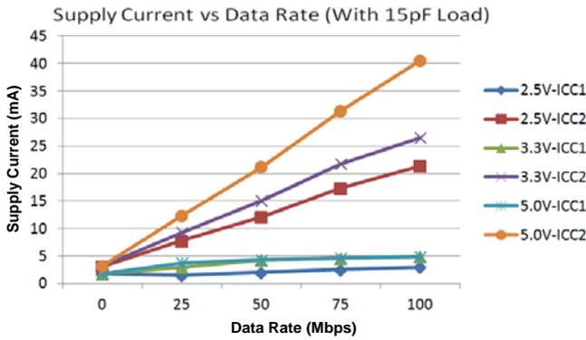
图 9-1. 电源电流 vs. 数据率
