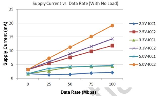
图 9-2. 电源电流 vs. 数据率
