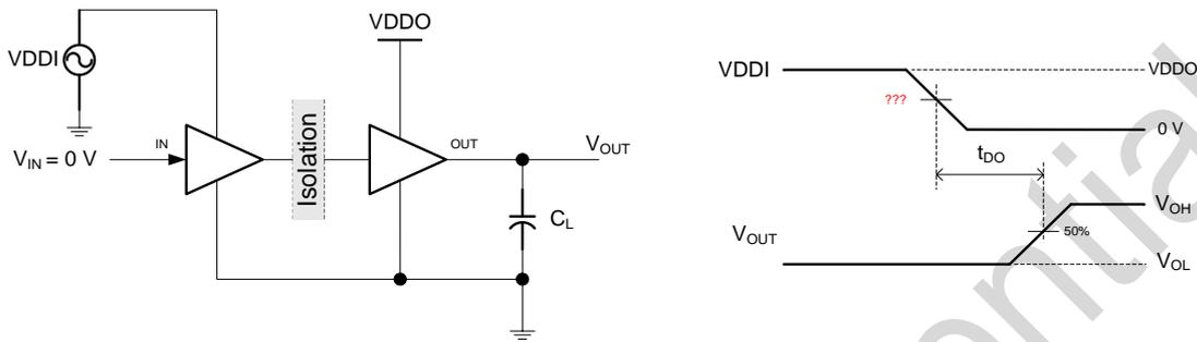
图 8. 缺省输出延时测试电路和电压波形
